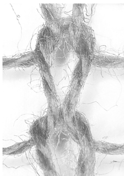
图 1 平纹线圈形态
