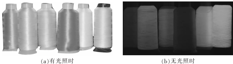
(a)有光照时 (b)无光照时 图 1 夜光纤维有光照和无光照条件下的外观对比
